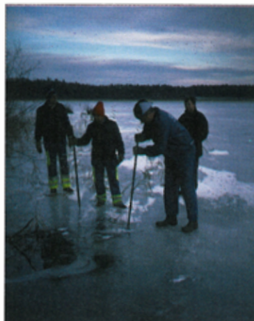
Bild 1.11. Sticksondering för att klarlägga om ett tätande botten-skikt av lera eroderats bort och underliggande sand- och grus-avlagring frilagts så att ytvatten läckt till grundvattenmagasinet under sjöns botten (Brygga, Ekerö kommun).
