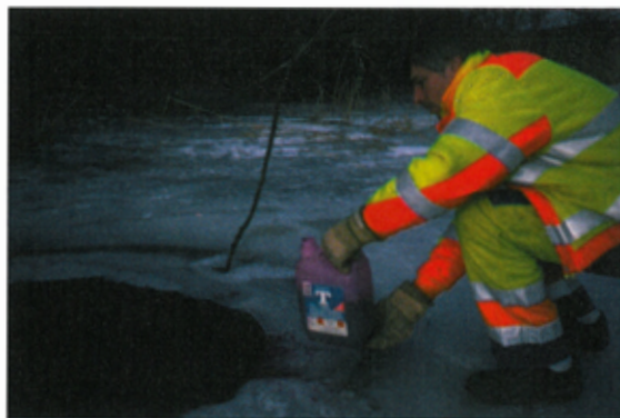
Bild 1.10. Spårämnesförsök med färgämne (kaliumpermanganat) för att lokalisera ett inläckage av ytvatten till ett grundvattenmagasin vid Brygga, Ekerö kommun.
