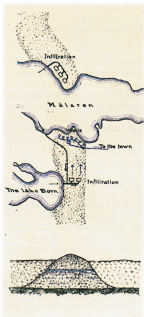
Bild 1.8 Förslag från sekelskiftet för Stockholms vattenförsörjning baserat på infiltration vid Bornsjön och på Ekerö (Richert, 1900).
