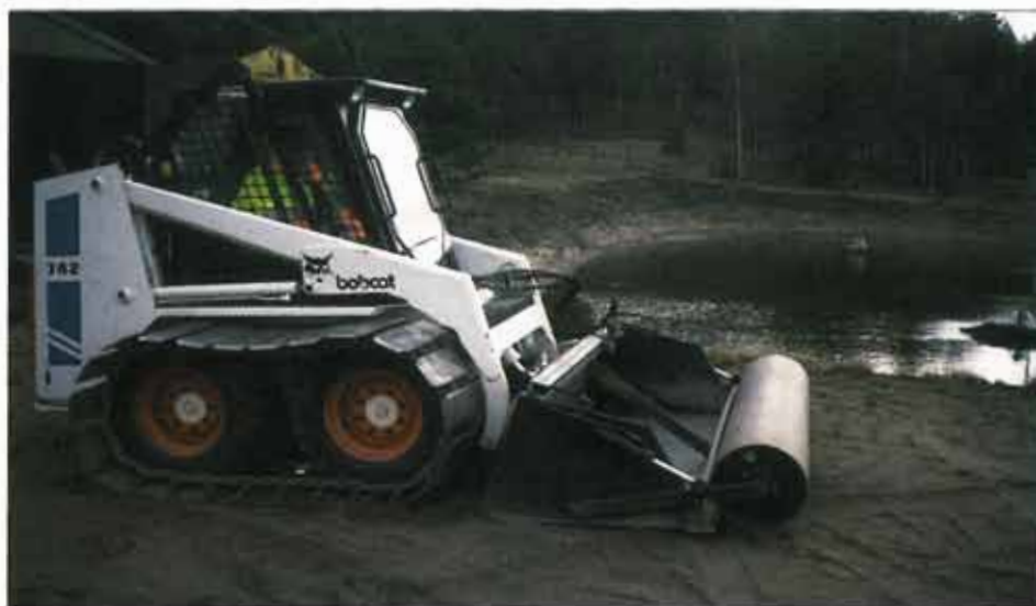
Bild 3.36 Bobcat med rensningsutrustning. Bilden är tagen vid infiltrationsanläggningen i Fjärås, Kungsbacka.
