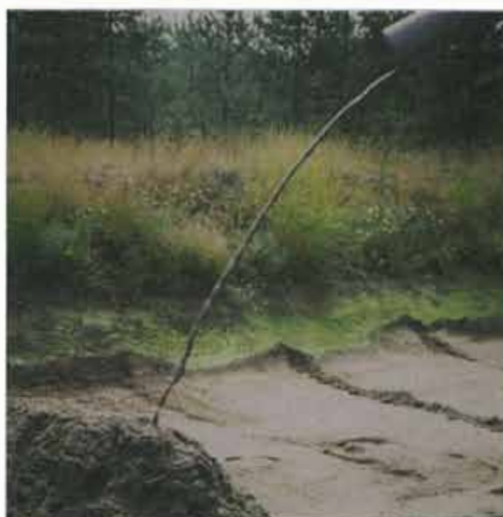
Bild 3.41. Mobil utrustning för sandtvätt. Bildsvit från Södertäljes infiltrationsanläggning vid Källtorp. Överst t v skrapas filterhuden ihop till högar. Överst t h bearbetar maskinen högarna med filtersand. Nederst t v sker tvättning i cykloner. Nederst t h återförs den tvättade sanden till bassängerna.
