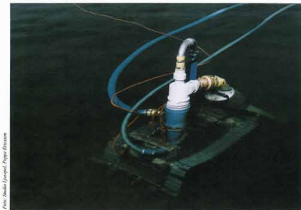
Bild 3.42. Prototyp av en rensningutrustning för infiltrationsbassänger och långsamfilter som arbetar under vatten (Weda Vatten).
