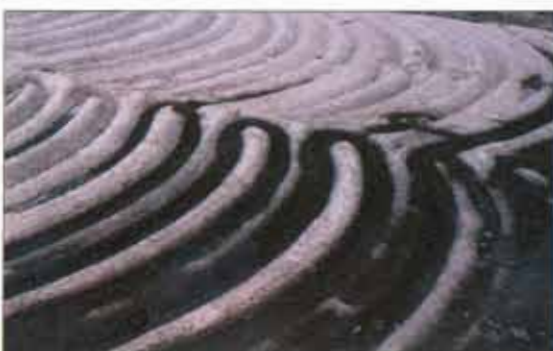
Bild 3.19 Försök med fåror i bassängbotten för att öka infiltrationsytan vid Källtorp, Södertälje. Fårorna hade en tendens att raseras vid den första påfyllningen.
