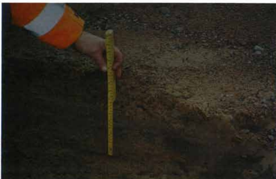
Bild 3.5 Tunt lerskikt under en filterbädd vid Kungsbackas infiltrationsanläggning i Fjärås. Finskiktet orsakade dämning i infiltrationsbassängerna och grävdes därför bort.
