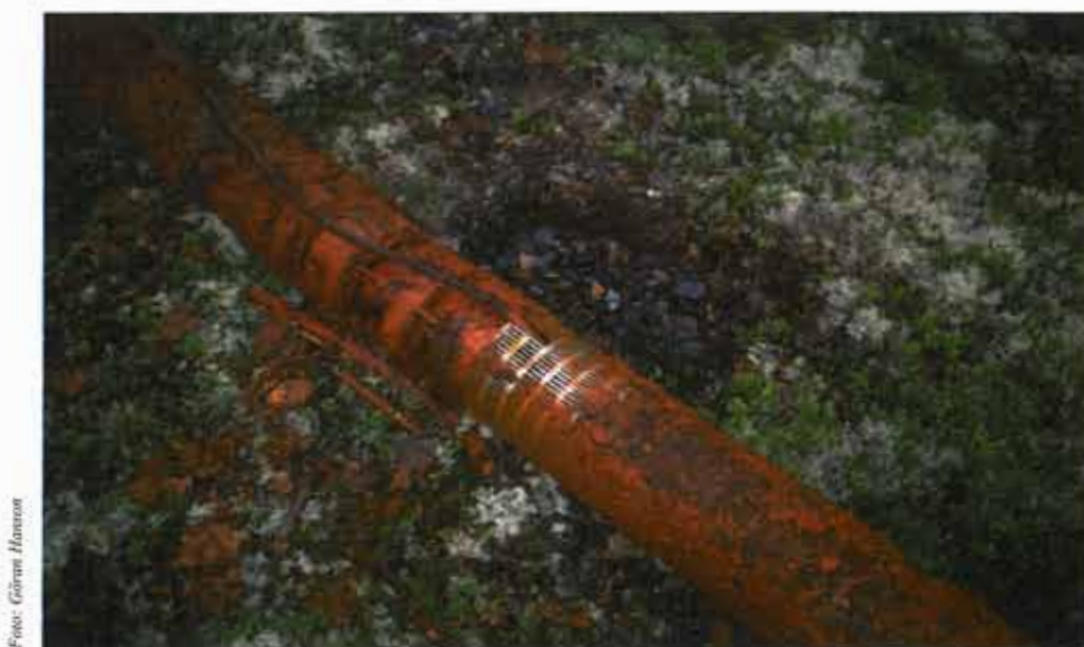
Bild 3.45 Kraftiga järnutfällningar på dränkbar pump vid Gäddvik, Luleå.
