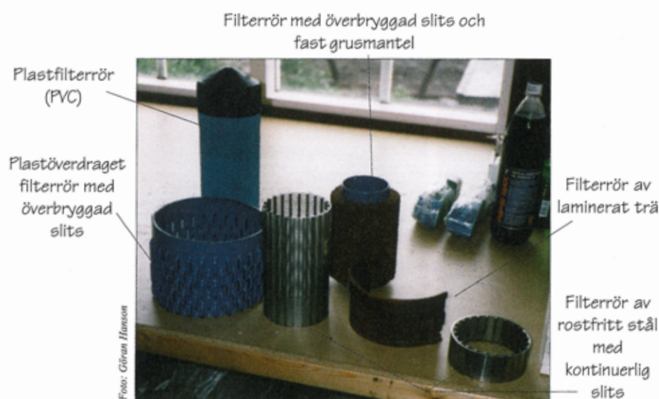
Bild 3.25. Demonstrationsexemplar av olika brunnsfilter.
