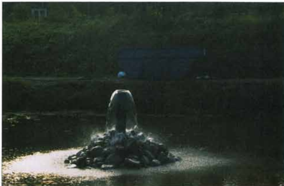
Bild 3.27. Spårämnesförsök vid infiltrationsanläggningen Skantzen, Hallstahammar. Koksalt från containern i bakgrunden injicerades i bassängen. Kloridhalten registrerades i en uttagsbrunn ca 800 m från infiltrationsplatsen.
