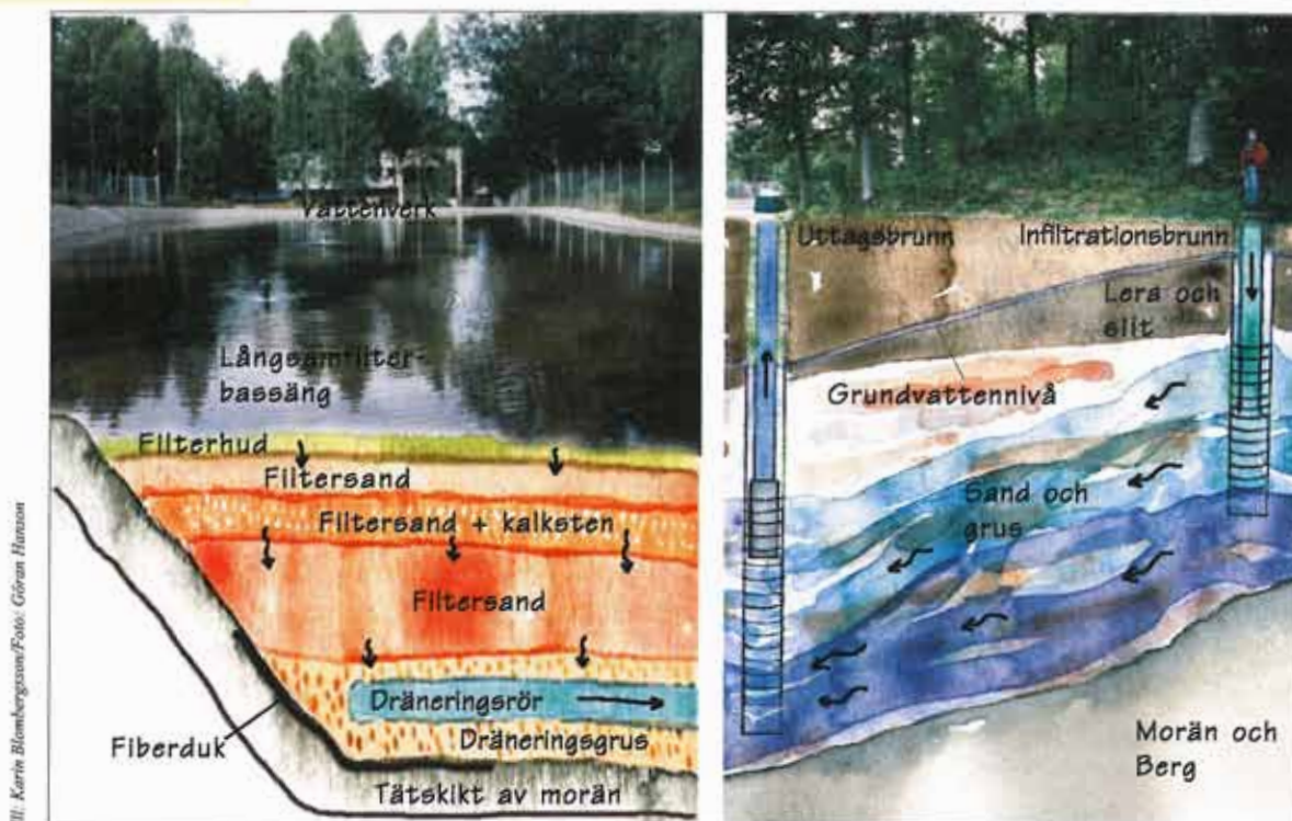
Bild 4.9. Djupinfiltration (infiltration på brunnar) vid Lilla Holje, Olofström. Förbehandling av råvatten från sjön Halen görs med långsamfiltrering. I filterbädden har inblandning av kalksten gjorts för att öka vattnets pH, alkalinitet och hårdhet (bilden t v). Det förbehandlade vattnet leds därefter till infiltrationsbrunnar och pumpas upp i uttagsbrunnar. På bilden t h ses en infiltrationsbrunn och en uttagsbrunn. Avståndet mellan dessa är ca 75 m.
