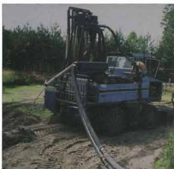
Bild 3.41. Mobil utrustning för sandtvätt. Bildsvit från Södertäljes infiltrationsanläggning vid Källtorp. Överst t v skrapas filterhuden ihop till högar. Överst t h bearbetar maskinen högarna med filtersand. Nederst t v sker tvättning i cykloner. Nederst t h återförs den tvättade sanden till bassängerna.
