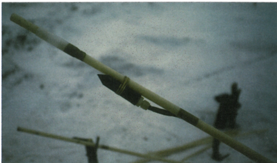
Bild 7.4. Detalj av en markvattenspets under installation i en infiltrationsbassäng vid Hyndevadsverket, Eskilstuna. Spetsen som är gjord av teflon med en porstorlek av 1-5 \mu\text{m} .
