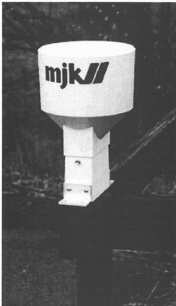
Figur 4.3 Regnmätare av vippskålstyp
