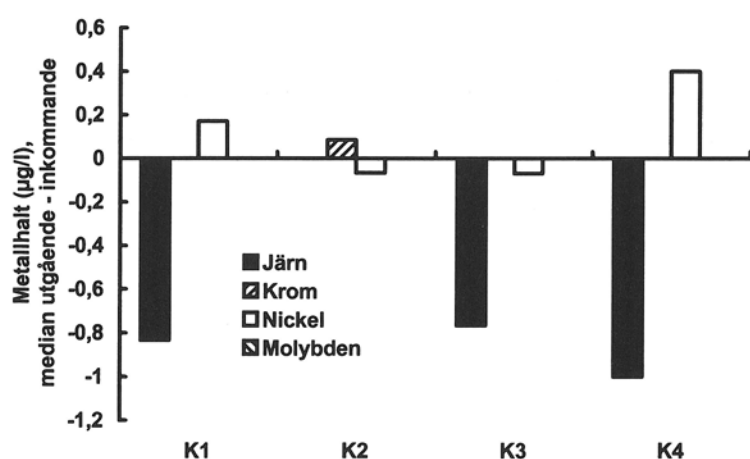
Figur 14. Medianvärden av utgående minus inkommande metallhalter i testriggar i fyra svenska kommuner.
