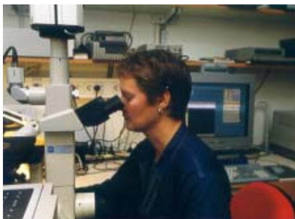
Fig.22, Konfokalmikroskopet är ett avancerat instrument för studier och karaktärisering av biofilmer. I högerspalten ges exempel på bilder från en biofilm uppifrån och ned på "djupen" 3, 9 respektive 12 \mu m.
