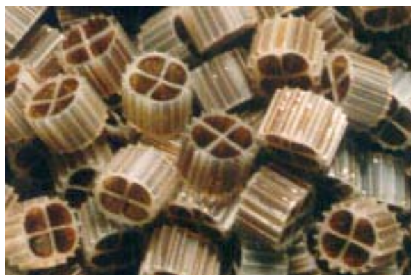
Fig.10, Kaldnes, bärarmaterial, i nästan naturlig storlek.
