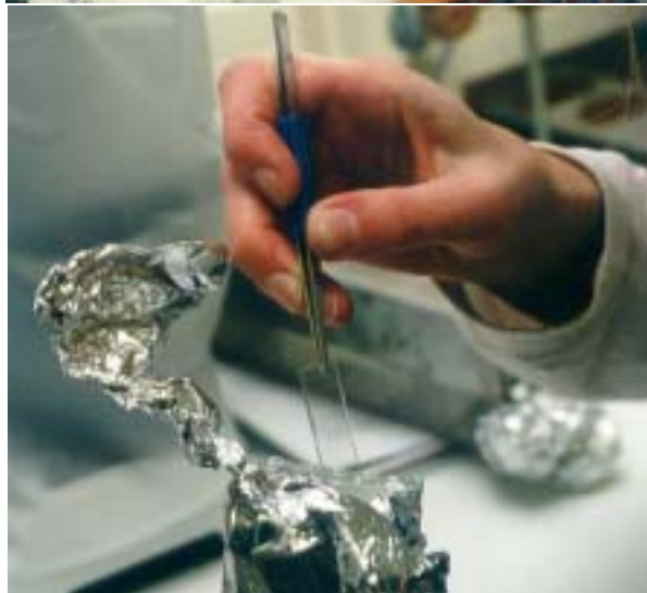
Fig.13, Preparering av biofilmkassetter - ett grannlaga arbete med steriliserat material.
