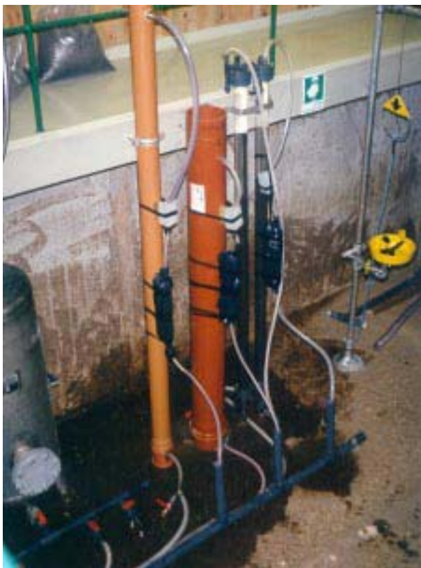
Fig. 12, I Sotenäs gjordes jämförande studier av olika biofilmsbärare, Natrix, BioFlow samt Leca-kross. Foto: Anders Claesson.
