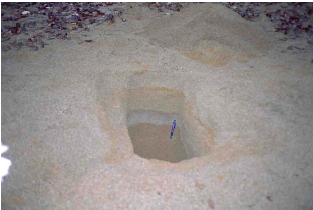
Skiktning i infiltrationsbädd. Den mörka linjen är järn och mangan som fällts ut i gränsszonen mellan filtersanden och kalklagret.
