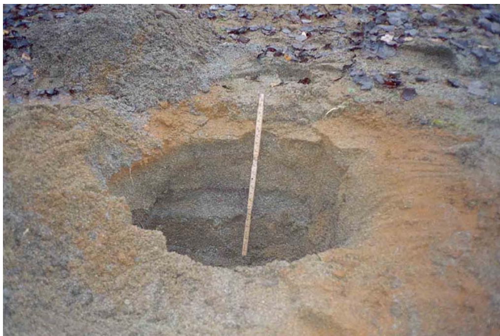
Skiktning i sandfilterbädden i Norrflärke visar en tydlig utfällning av järn och mangan
