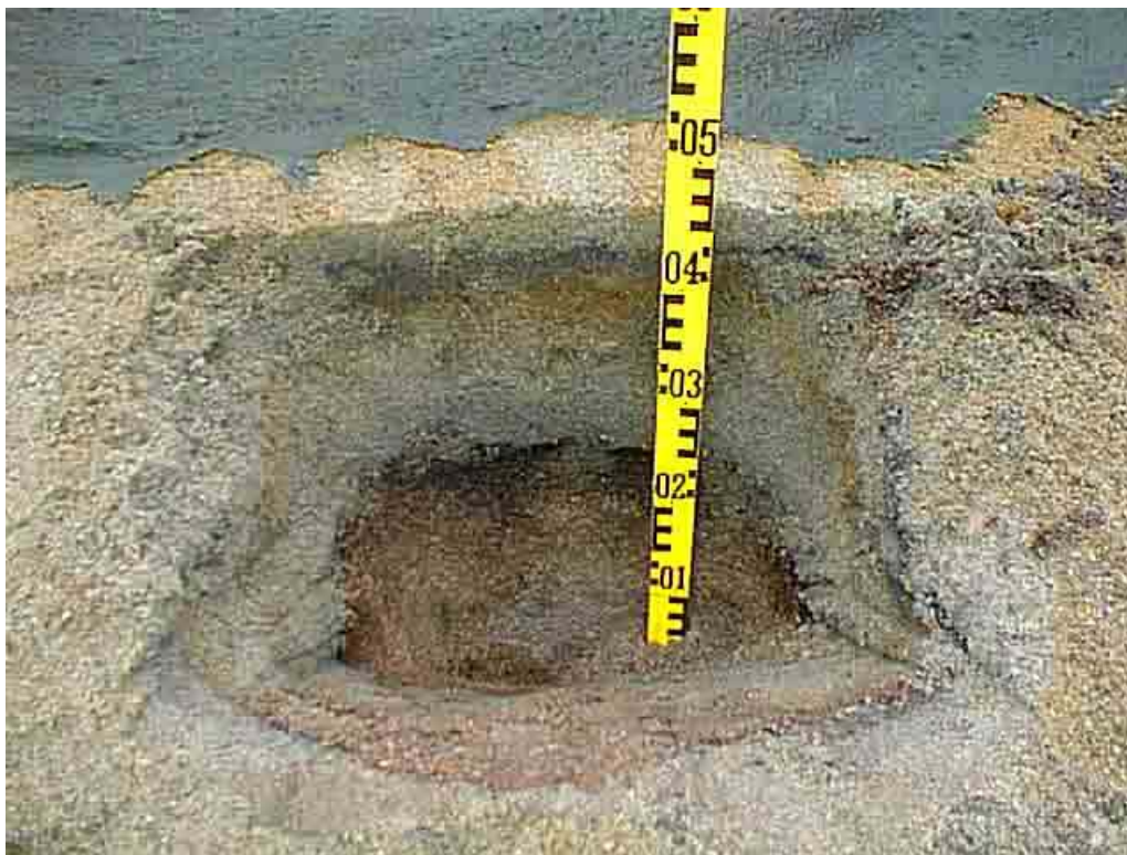
Skiktningar i filterbädden i Ytterhogdal
