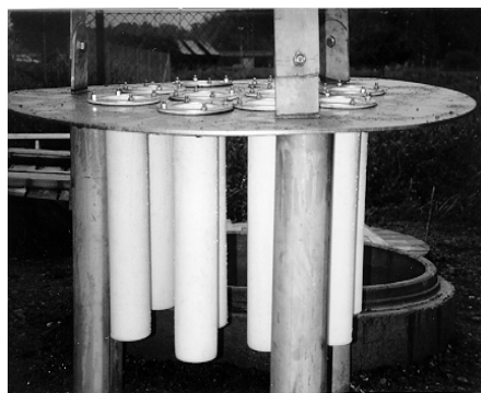
Figur 11. a) Filteranläggningen och b) permeabla plasttuber i filtersteg 1.
