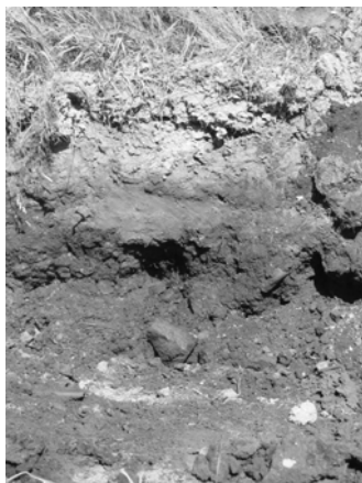
Figur 5.1. Markprofil på deponin i Hagby, Täby kommun. Överst finns ett ca 0,5 m tjockt täckskikt, därunder finns ett 0,05 m tjockt skikt som bedöms vara nedbrutet slam. Under detta är materialet lerigt och svart, ned till avfallet.
