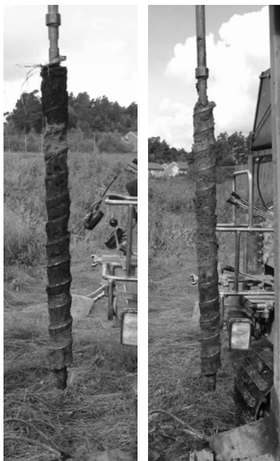
Figur 5.2. Bilder av markprofilen i Furulund. Till vänster: 0–1,0 m under markytan. Till höger: 1,0–2,0 m under markytan.
