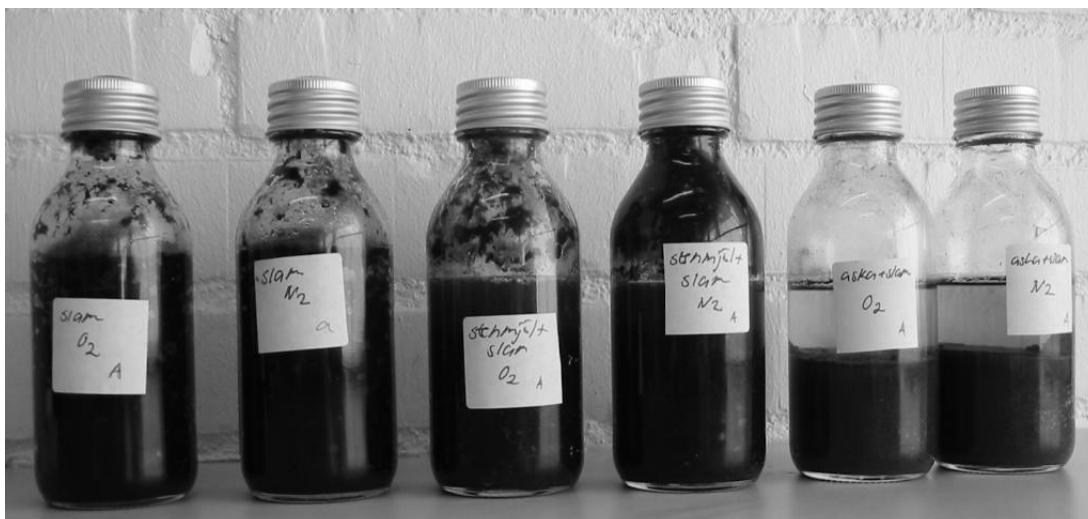
Figur 5.7. Provflaskor efter 79 dagar. Från vänster slam, aerob och anaerob, slam och stenmjöl, aerob och anaerob, samt slam och aska, aerob och anaerob. I de fyra vänstra syns gasbubblor i massan, medan slam/aska har bildat ett hårdare skikt på flaskans botten.
