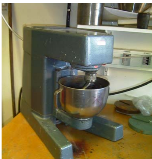
Figur 3.1. Assistentmaskinen som användes vid tillverkning av proverna (Lenströmer 2002).
