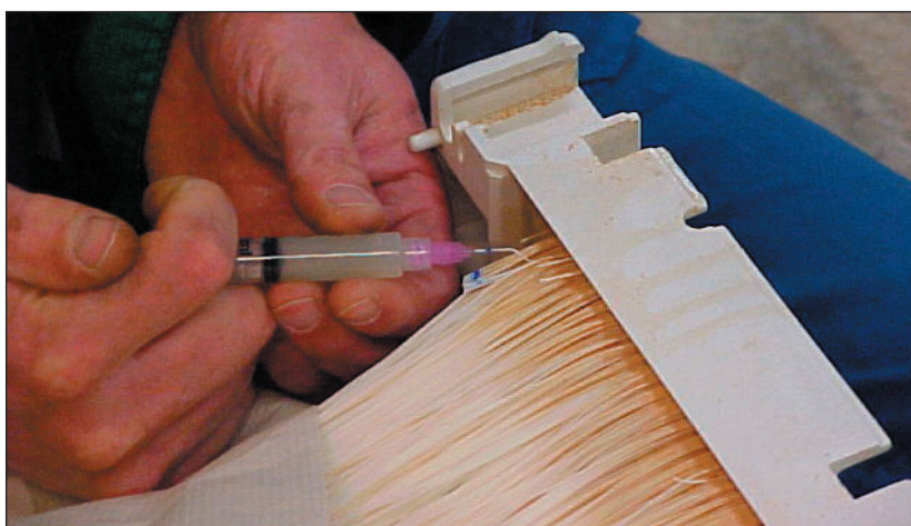
Foto 4-9. "Pluggning" med silikon av öppna ändrar av membranfibrer. Fibrerna avklippta och tagna till analys. Öppna fiberändar innebär att en liten mängd vatten kan passera utan att filtreras. "Täthetskontroll" görs med MIT (Membrane Integrity Test).
