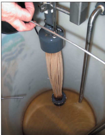
Foto 4-4. Knippe med ZeeWeed 500-membran efter spolning och omrörning med luft. Lägg märke till ansamlingen av föroreningar på de ljusa membrantrådarna vid den nedre infästningen och på botten av behållaren.
