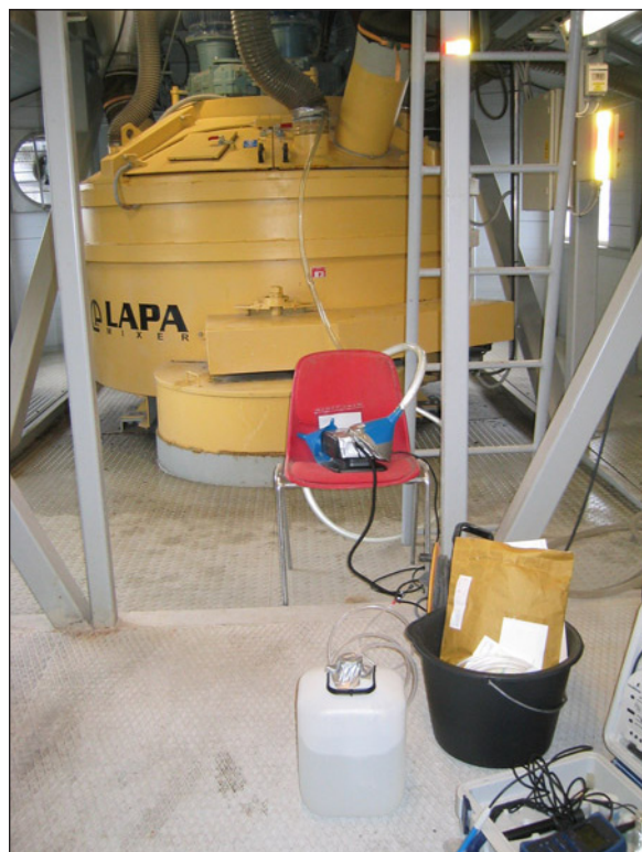
Figur 6-1. Försöksuppställning. Blandningskammare för Monofill och RGR (rökgasreningsrest från avfallsförbränning). Luft sugs via en kompressor från ventilationskanal till blandaren. Luften tillåts sedan passera vatten i dunken i förgrunden.
