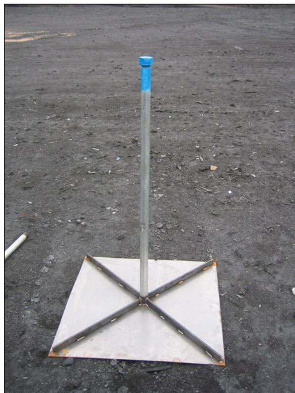
Figur A-2. Exempel på sättningspegel.
