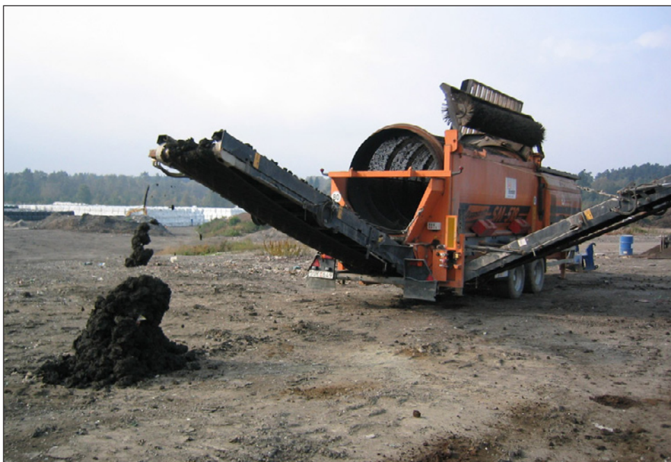
Figur 4-8. Vid Renova användes en trumsikt för blandning av slam och aska.
