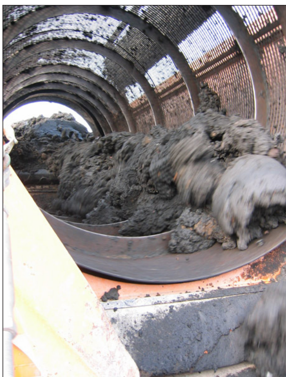
Figur 4-9. Omblandning och utmatning från trumsikt vid Renova.
