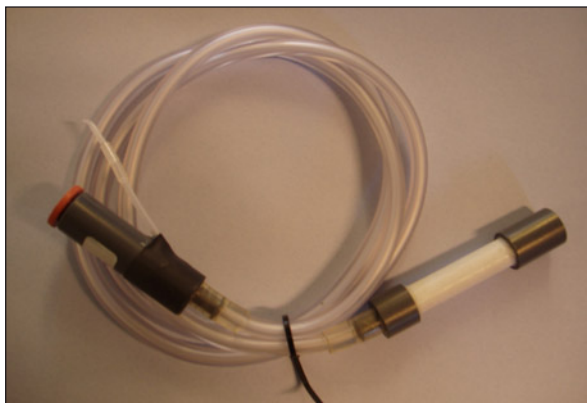
Figur H-1. Gasprob för provtagning av markgas.
