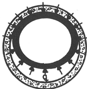
Figur 13.10: Friliggande foderrör påverkat av upptryck.
