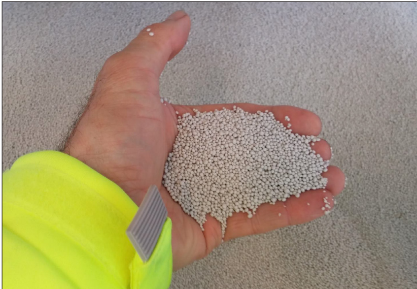
Figur 3.9 Färdig struvit med följande sammansättning: P 12,5 procent, N 5,5 procent och Mg 10 procent. Innehållet av Cd är extremt lågt, < 0,02 mg/kg, motsvarande en Cd/P-kvot på 0,2.
