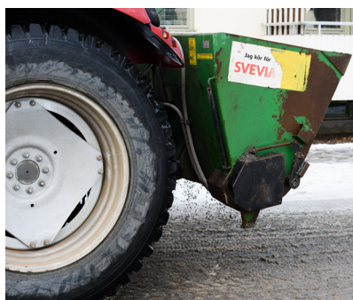
Figur 3.2 Grus och sand från halkbekämpning är en källa till partiklar i dagvatten.
