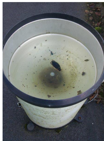
Figur 3.28 Regnmätare där bristande underhåll lett till att mätaren har satts igen.
