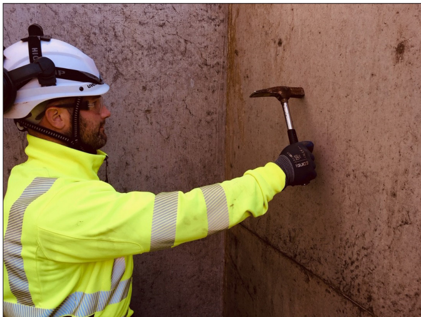
Figur 5.1 Bomknackning med hjälp av en hammare.
