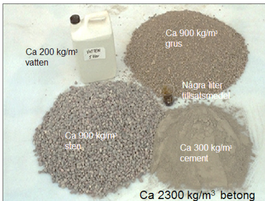
Figur 4.1 För att tillverka en kubikmeter färdig betong behövs ungefär 300 kg cement, 200 kg vatten, 1800 kg ballast och ett par kilo tillsatsmedel.
