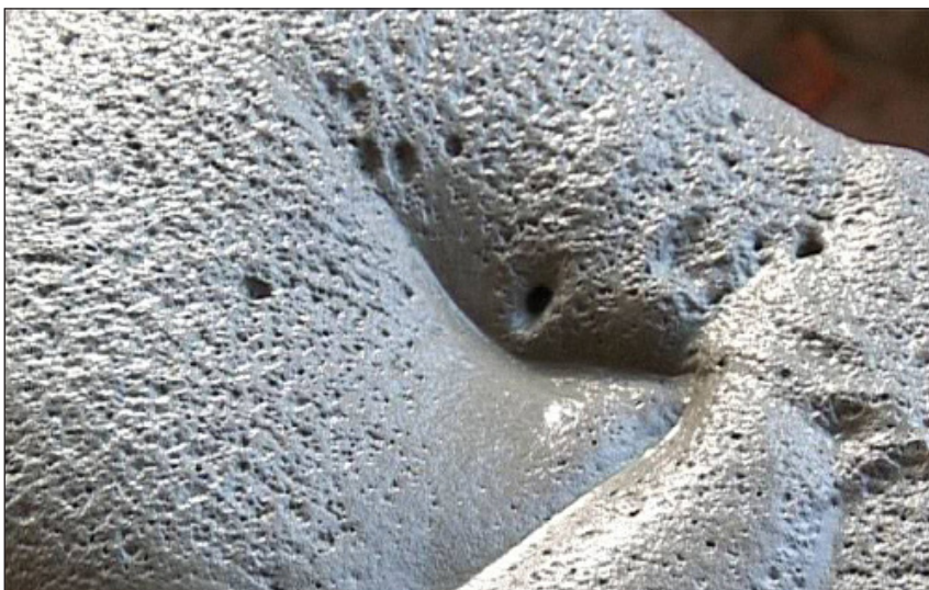
Figur 4.7 Skumbetong är ett poröst och värmeisolerande fyllnadsmaterial.
