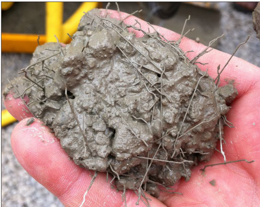
Figur 4.3 Stålfiberbetong är betong vilken är armerad med stålfiber.
