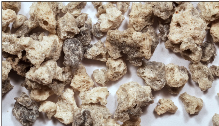
Figur 4.19 Slagg från masugn med oregelbunden kornform.
