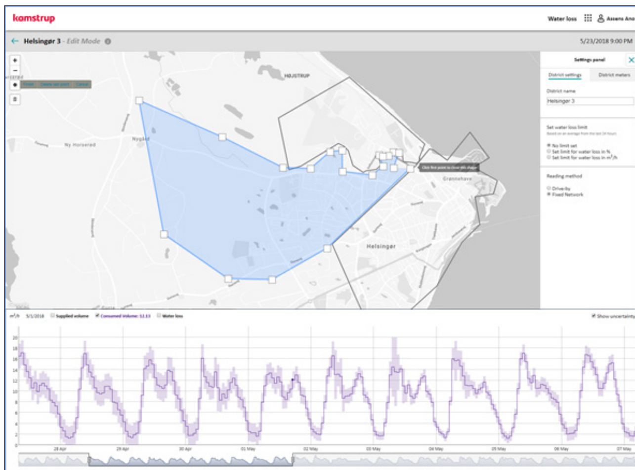
Figur 6.14 En skärmbild av en lösning som identifierar vattenutläckage baserat på en samanställning av data från smarta vattenmätare i Kastrup. ( www.Kamstrup.com )
