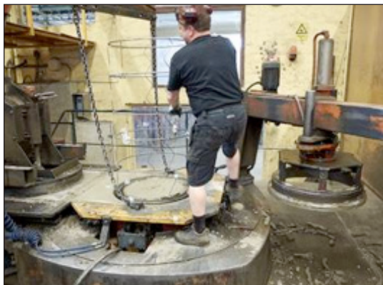
Figur 4.2 Placering av armering i form, Meag
