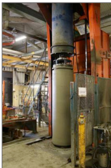
Figur 4.5 Formen avformas direkt efteråt.
