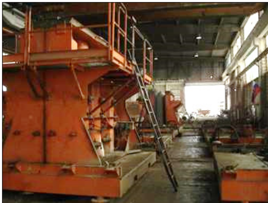
Figur 4.9 Kvarvarande form 24 timmar efter gjutning och sedan avformning, Berding beton
