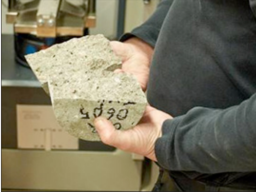
Figur 4.16 Den spräckta provkroppen
