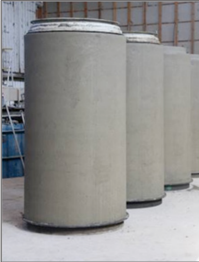
Figur 3.6 Tillverkade betongrör på härdning, S:t Eriks
