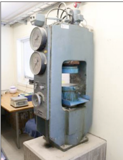
Figur 4.18 Tryckpress för tryckhållfasthet, S:t Eriks
