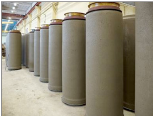
Figur 3.1 Härdning av rör, Meag
