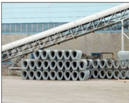
Figur 3.4 Upplag av äggformade betongrör, Meag
