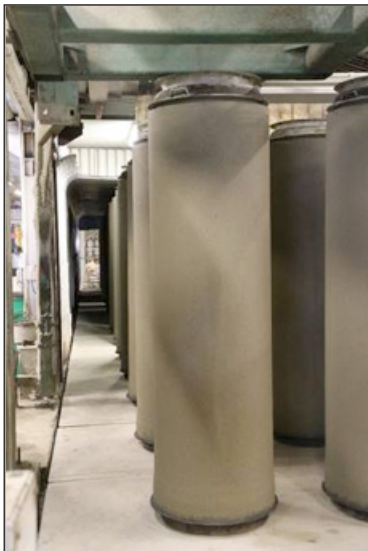
Figur 4.8 Härdning betongrör, S:t Eriks
