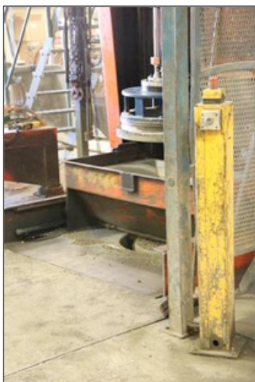
Figur 4.4 Jordfuktig betong fylls i form.
