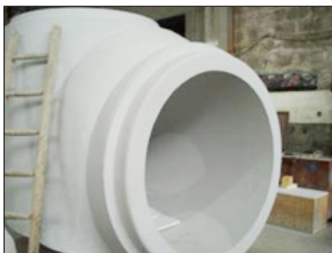
Figur 3.11 Betongbrunn som målats vit, Berding Beton, Dormagen
