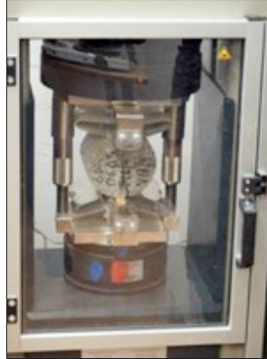
Figur 4.17 Provning av spräckhållfasthet vid 28 dygn
