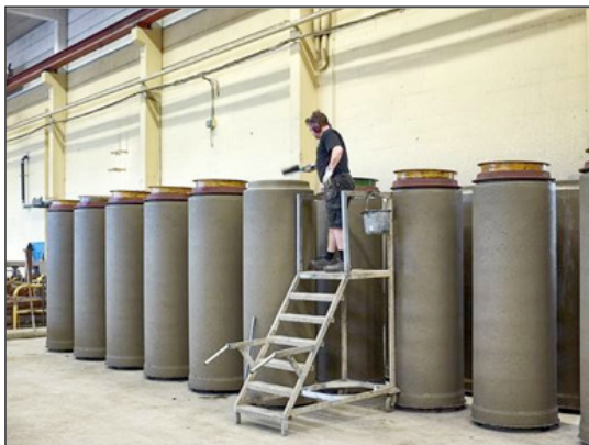
Figur 4.7 Härdning av betongrör
