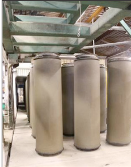
Figur 3.7 Tillverkade betongrör på härdning, S:t Eriks
