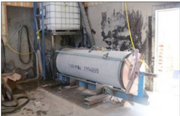
Figur 4.19 Provning av vattentätthet, S:t Eriks
