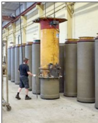
Figur 3.2 Avformning av jordfuktigt betongrör, Meag
