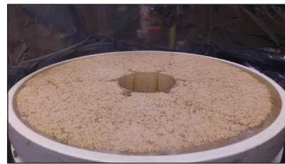
Figur 2.5 Änden på ett hålfibermembran.
