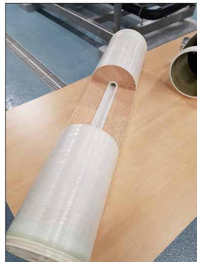
Figur 2.4 En uppskuren spirallindad modul med kanalen i mitten som samlar in permeatet.
