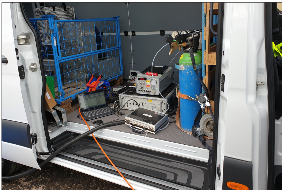
Figur 2.5 Instrumentering för utförande av metanmätning på Nykvarnsverket.
