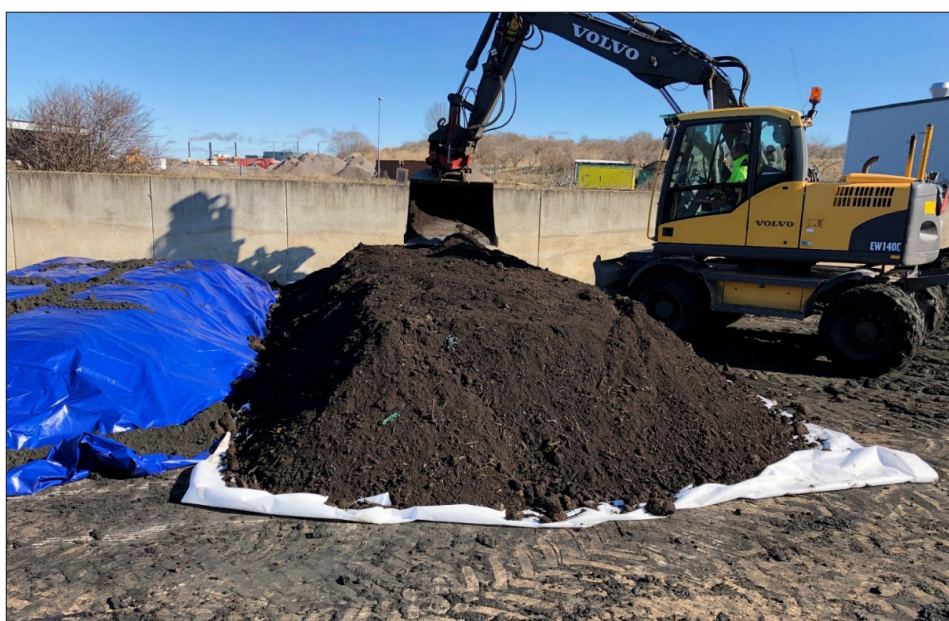
Figur 3.4 Täckning av avvattnat slam med kompostmaterial. Till vänster i bild är slamhög med ureainblandning och täckning med presenning.
