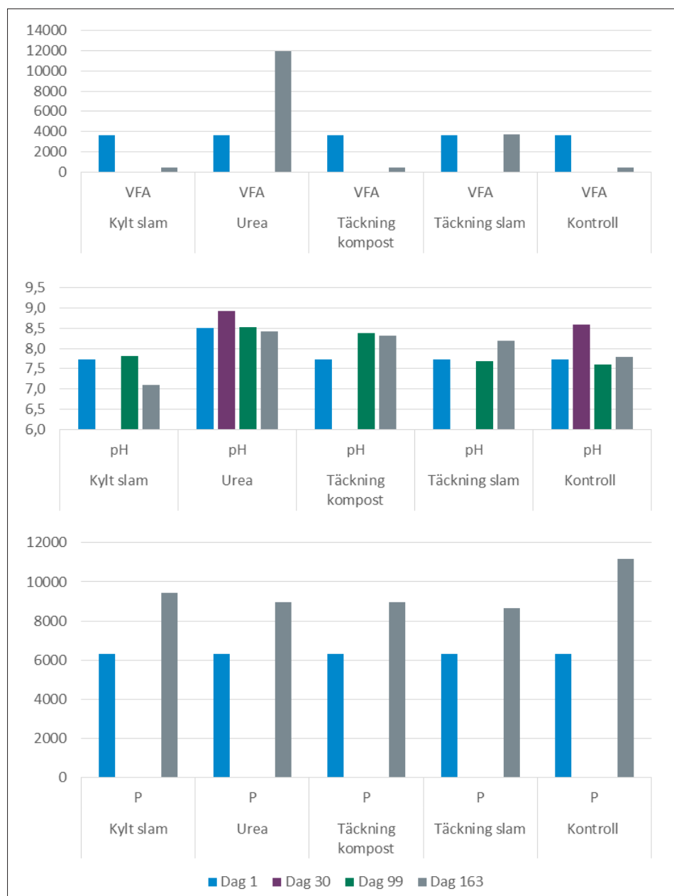
Figur 7.6 Fosfor (mg/kg), pH och VFA (mg/l) i pilotförsöket.
