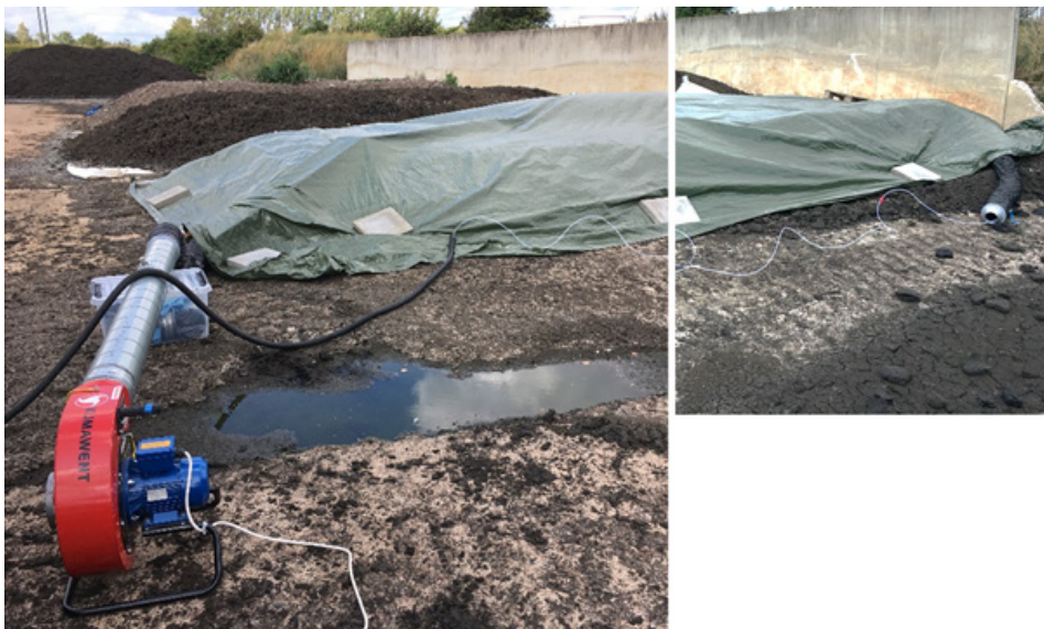
Figur 2.6 Mätning av metanemissioner från en slamhög på Nykvarnsverket.
