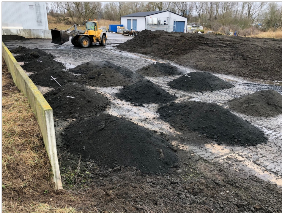
Figur 3.2 Utförande av naturlig kylning och mätning av temperatur med temperaturlogger BIODEGMA®.
