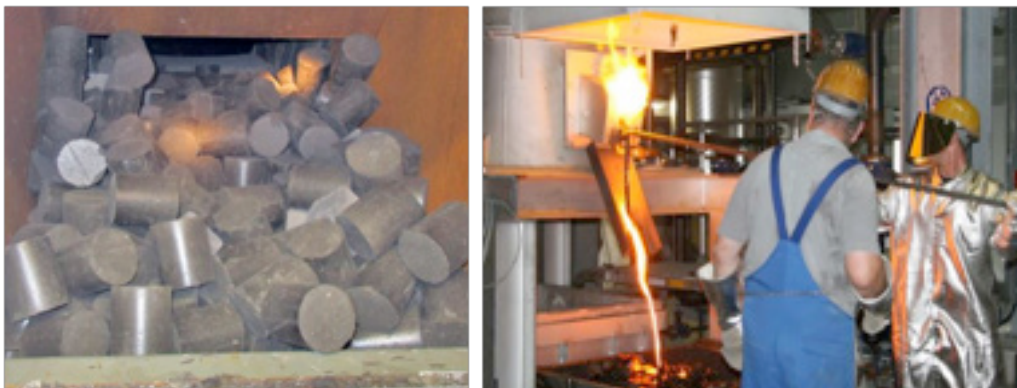
Figur 2-6 Till vänster de briketter av torkat slam som matas in i reaktorn. Till höger slagguttag från reaktorn, från juli 2016.
