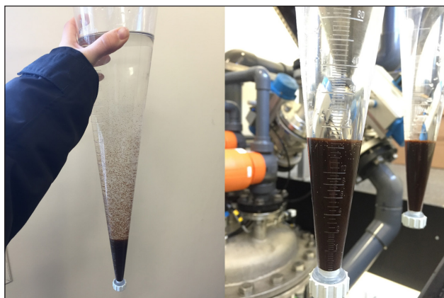
Figur 3.1 Mätning av dos jonbytarmassa i sedimenteringskoner. Till vänster: jonbytarmassa som sedimenterar i 1 L vatten. Till höger: avläsning av halt jonbytarmassa i mL.
