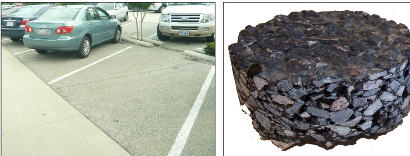
Figur 10.3 Permeabel betong bredvid vanlig betong på en parkering; borkkärna från permeabel asfalt (porerna genom vilka vattnet infiltrerar syns tydligt)
