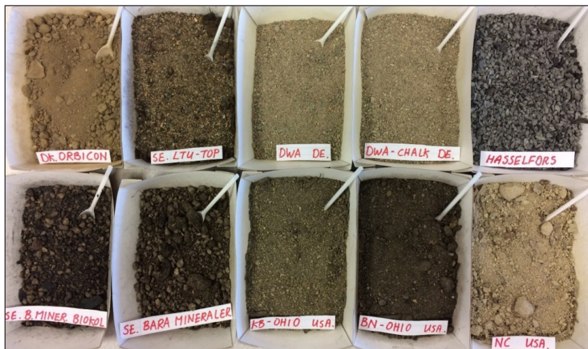
Figur 9.8 Filtermaterial med olika egenskaper (Foto: Laila Søberg)
