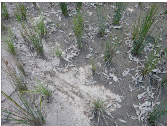
Figur 9.7 Yta på igensatt biofilter
