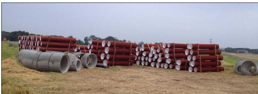
Figur 2.4 Exempel på homogena ribbade rör av PP. Foto: Mårtensson.
